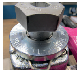
Abb. 13: Sprengling umlaufend vertieft in der Ansenkung positioniert
