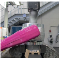
Abb. 11: Auflage des ACP zur Demontage der Schraube
